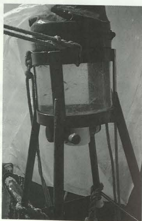
Bild 7. Planktonprovet samlas i en plastburk försedd med ett finmaskigt nät i botten. (Foto Stig Fonselius)
