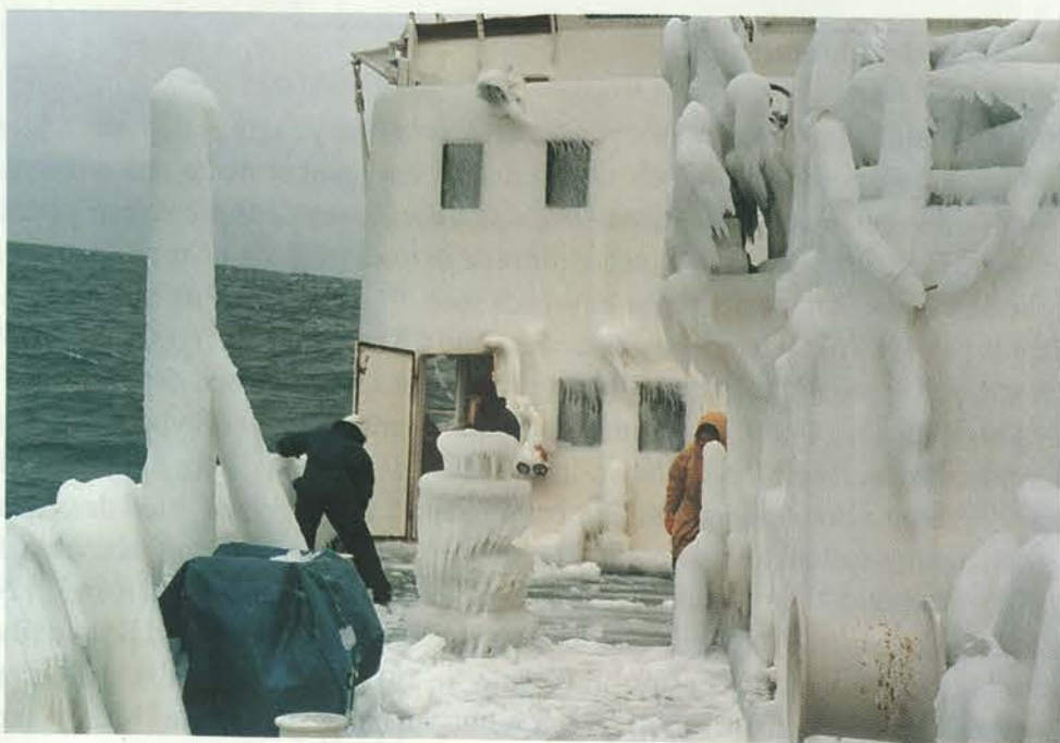
Bild 4. U/F ARGOS i vinterskrud. Nedisning kan vara mycket farligt på grund av att istäcket snabbt växer och fartyget kan då förlora sin stabilitet och kantra om isen inte genast avlägsnas. (Foto Lars Hansson)
