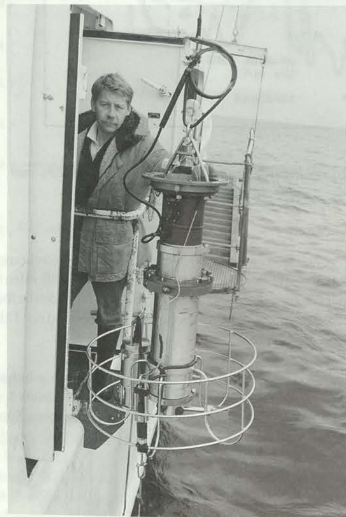
Bild 5. Provtagning med Rosettevattenhämtare. Vattenhämtarna är placerade i en krans kring en CTD-sond och kan stängas individuellt på önskat djup. Sonden är kopplad till en dator på däck som räknar ut salthalten från konduktiviteten och temperaturen samt djupet från trycket. Ingen vattenhämtare med på bilden. (Foto Göran Eriksson)
