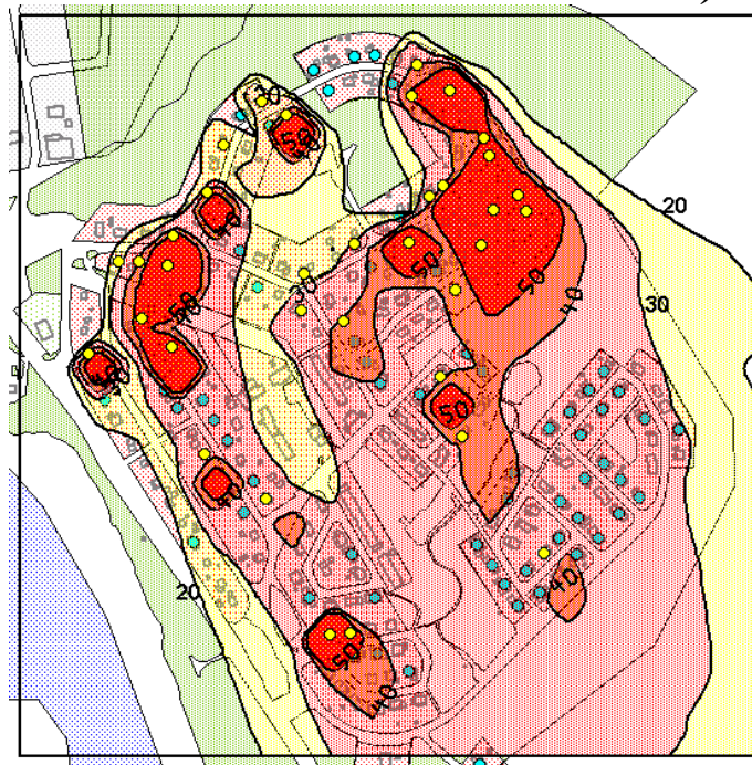
Figur 19. Beräknade 98-percentil halter (dygnsmedel) av förbränningspartiklar ( \mu\text{g}/\text{m}^3 ) med meteorologiska data för år 2001 från Lycksele flygplats. Emissionsdata har temperatorkorrigerats enligt aktivitetsfunktionen för centrum (figur15). Gula punkter anger äldre icke miljögodkända pannor och blå punkter anger övriga pannor enligt EDB Tot03.
