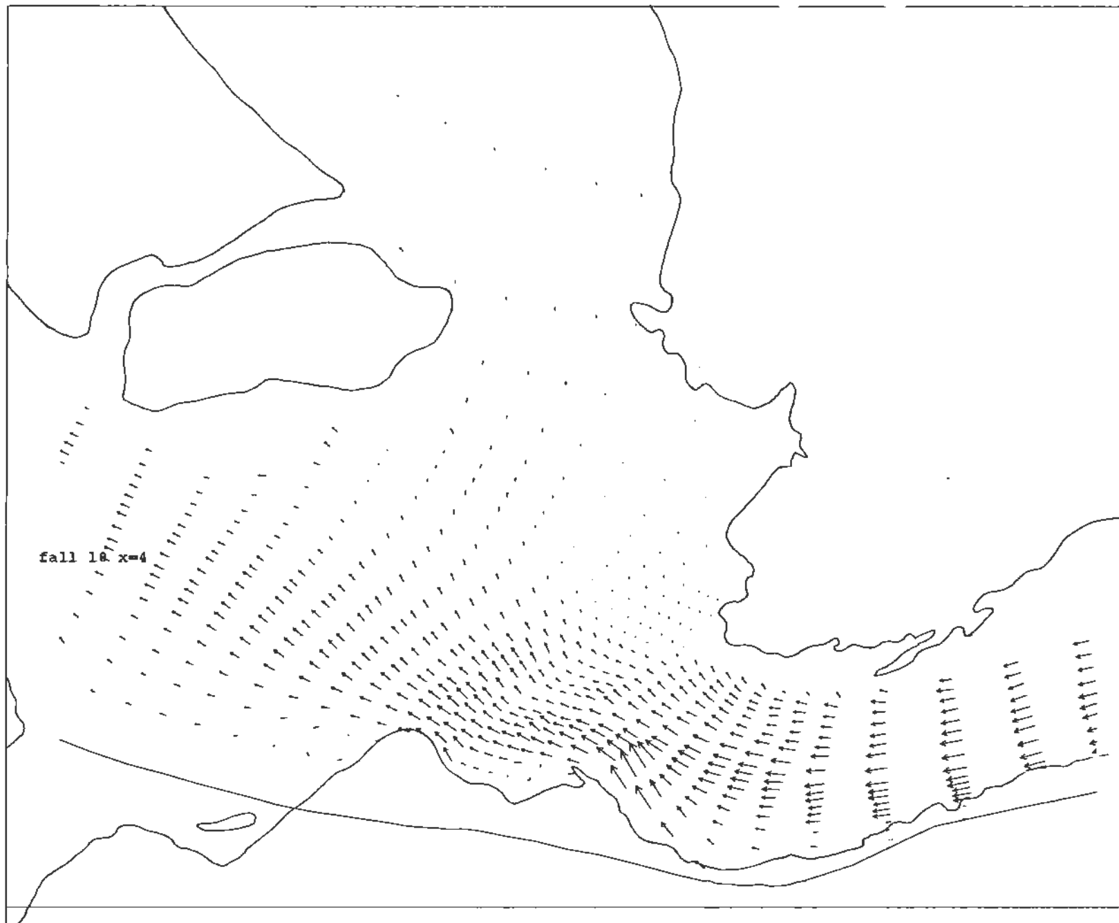
Figur 18 Simulerade strömmar i skiktet närmast under isen; fall 18, W=+0.5 m, Q=2500 m 3 /s, ej is, muddrad grop.
