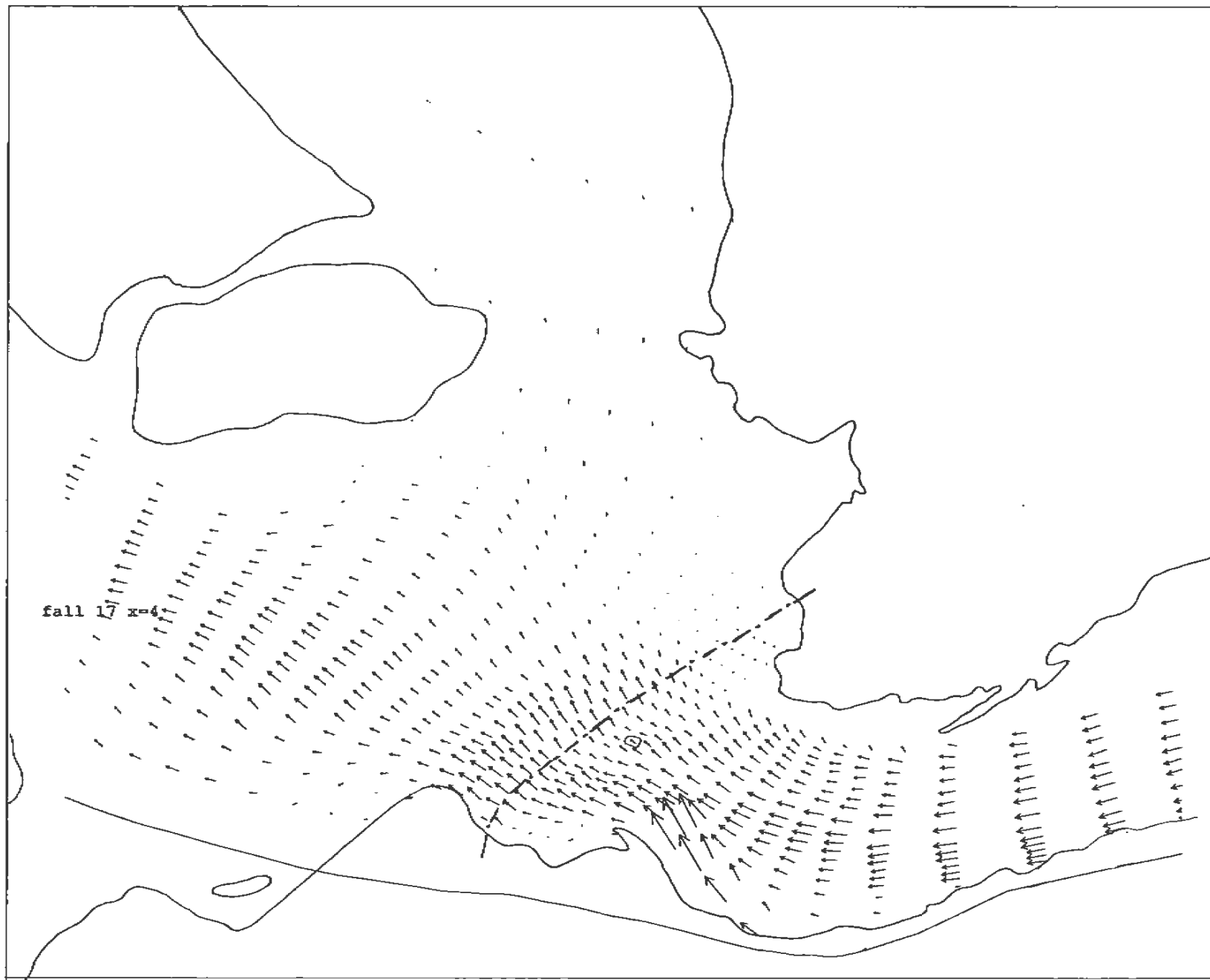
Figur 17 Simulerade strömmar i skiktet närmast under isen; fall 17, W=+0.5 m, Q=2500 m 3 /s, fast is, muddrad grop.
