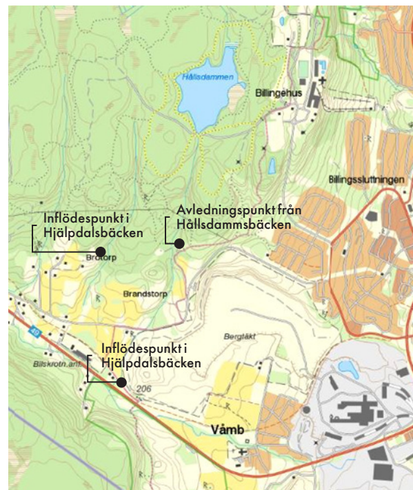
Figuren visar en översikt över det aktuella utredningsområdet, med ungefärliga markeringar för avledningspunkt från Hållsdammsbäcken, inflödespunkt i Hjälpadalsbäcken och utloppspunkt mot Våmsbäcken.
