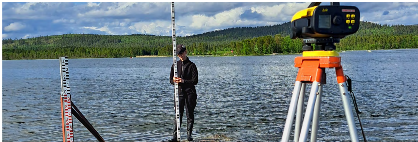
Nutida digital avvägning och effektiv datainsamling i fält.
