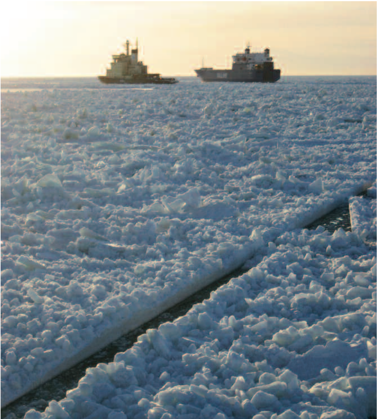
Här ses den skarpa glidkanten med intilliggande stampisvall som bildades i västra delen av Ålands hav den 3-4 mars. Finska isbrytaren SISU assisterar ett handelsfartyg med stora problem att ta sig fram för egen maskin pga kraftig ispress.
