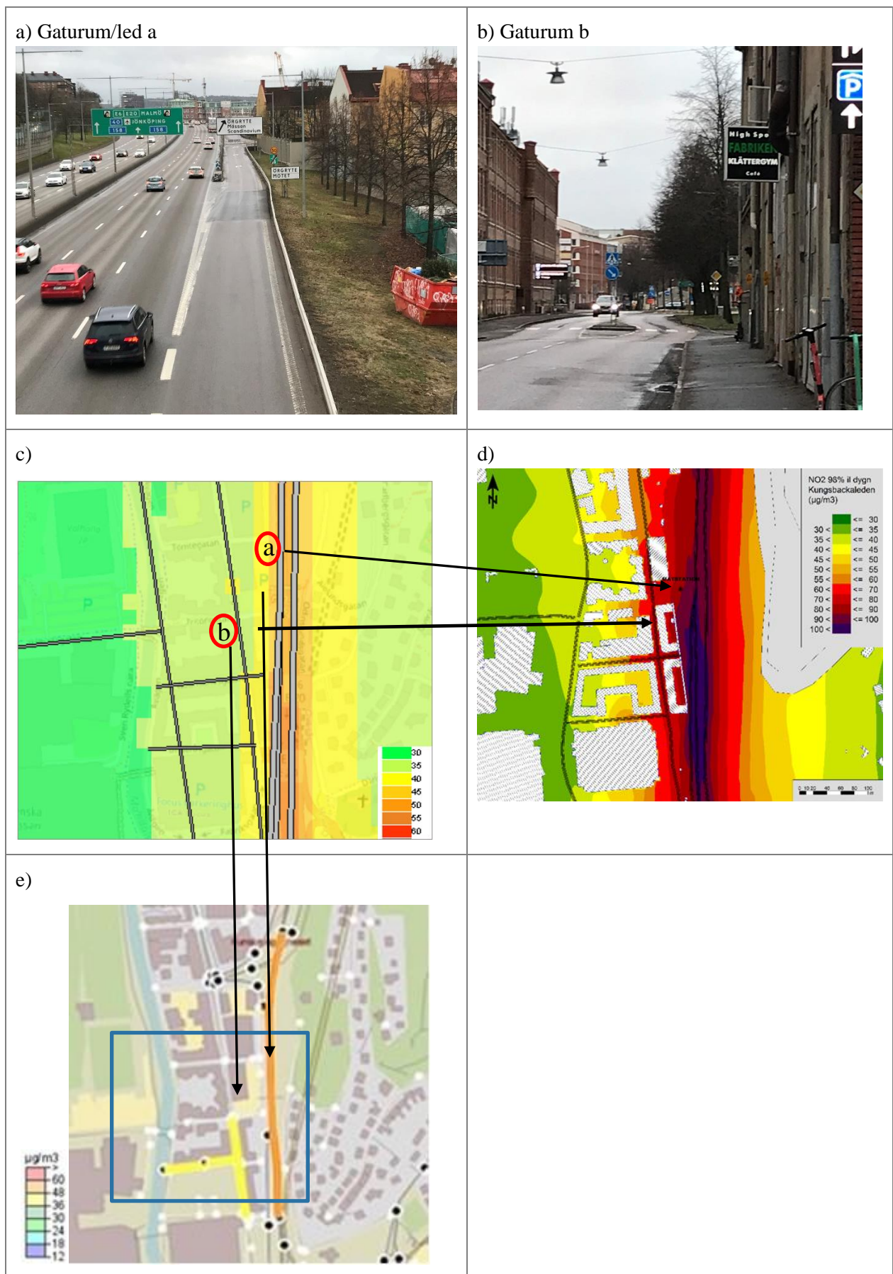
Figur 4. Illustration av två typer av gaturum, a) mycket trafikerad led, delvis enkelsidigt gaturum och b) dubbelsidigt gaturum med komplex bebyggelse och relativt mycket trafik. I c) visas resultatet beräknat med Gaussisk modellering, d) med CFD-modellering och e) med OSM-modell. Lokaliseringen av fotona anges i haltkartorna med a respektive b.
