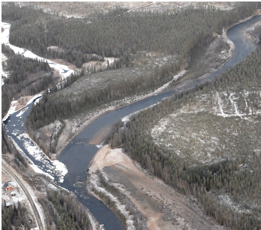
Figur 40. Flygbild från 2007-11-15 över sammanflödet mellan Klarälvens torrfåra (till höger) och Höljan (till vänster) under en tappning på 9,2 \text{ m}^3/\text{s} från dammen. Bilden visar en omfattande isbildning i Höljan medan torrfåran är isfri. Foto: Jan Tomperi.
