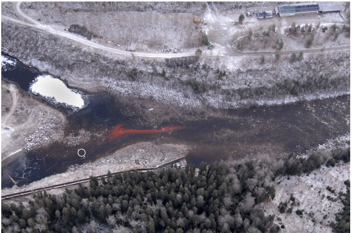
Figur 7. Spårämnet sprider sig snabbt nedströms (åt höger i bilden) efter injektionen vid INJ1 (markerat med vit cirkel i bilden) nedströms dammen den 15:e november 2007. Foto: Jan Tomperi.
