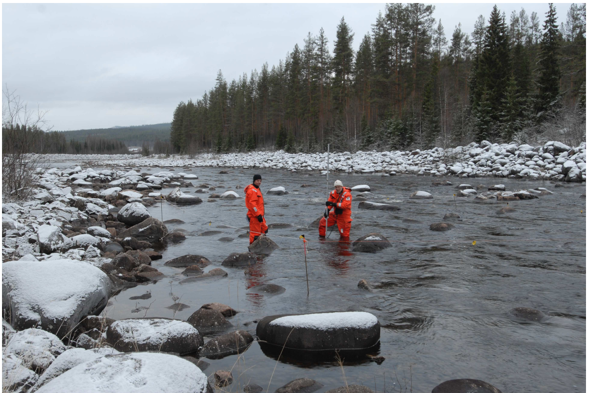
Figur 5. Punktmätningar av strömhastighet och vattendjup i kvadrattyta W4 tisdagen den 13/11 2007. I bilden skymtar armeringsjärn och snöre som användes för att markera kvadrattytans sidor. Foto: Jan Tomperi.
