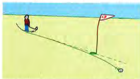
Fig 2 Oberoende av åt vilket håll på Söderköpings golfbana en golfboll puttats med en hastighet av 2 m/s kommer den efter 10 sekunder på grund av corioliskraften att ha avvikit 12 mm till höger.
