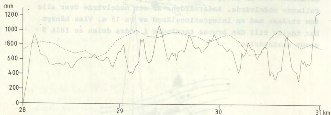
Figur 24. Vattenekvivalent i fält 3 mätt med radar (—) resp gamma (---) vid intensivmätningar 1984.
