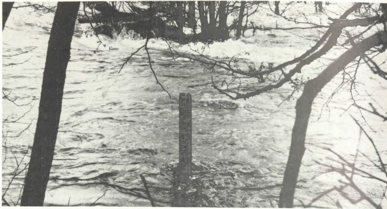
I bildens mitt finns en pegel för avläsning av vattenståndet. Foto: Jan Karlsson
