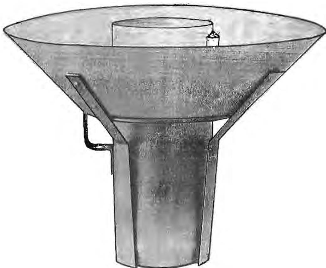
Figur 2.2. SMHIs standardmätare för mätning av nederbörd.
