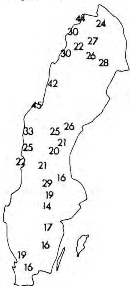
Figur 3.7. Exempel på beräknad extrem areell snösmältning (mm/dygn). (Källa: Brandt m fl, 1987.)
