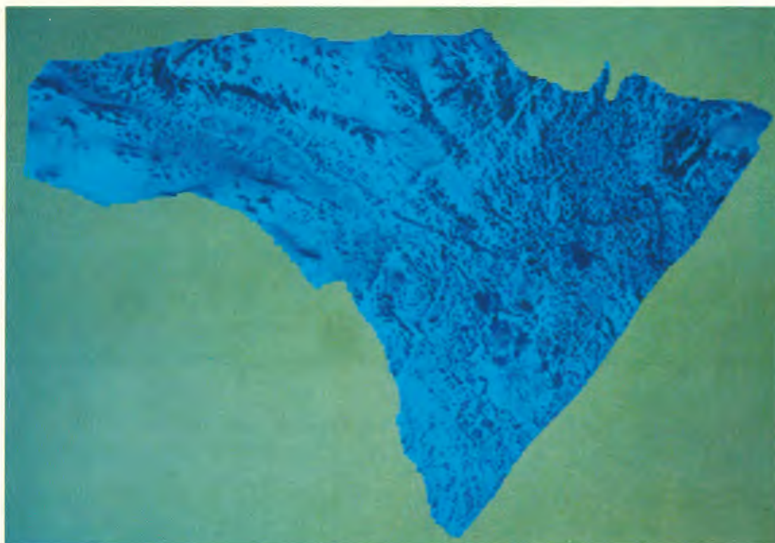
Figur 2. LANDSAT TM-bild (RGB) från 6 juni 1985 över den undersökta delen av Kultsjöns avrinningsområde (TM 5 rött, TM 4 grönt, TM 3 blått).
