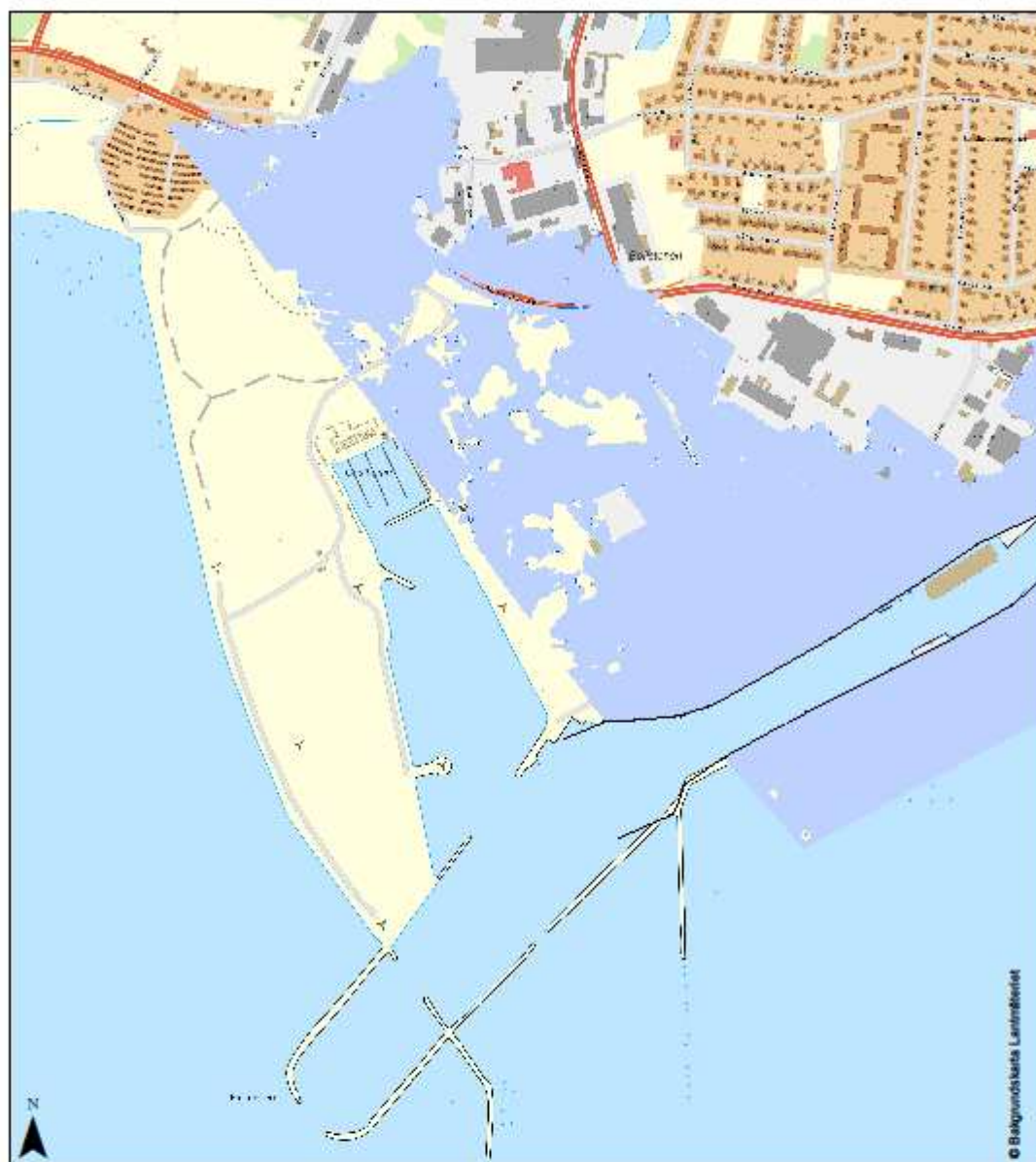
Bilaga 9c. Översvämningsskartering av Ätran vid Falkenberg med beräknat 100-årsvattenstånd i havet vid slutet av seklet. Karta 3.
