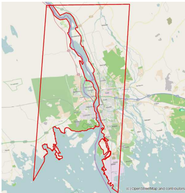
Figur 58. Röd polygon i kartbilden visar den avgränsning för Haparanda och Torneå som ligger till grund för areaberäkningarna. Översvämning innanför denna polygon har beaktats vid beräkning av översvämmad area.
