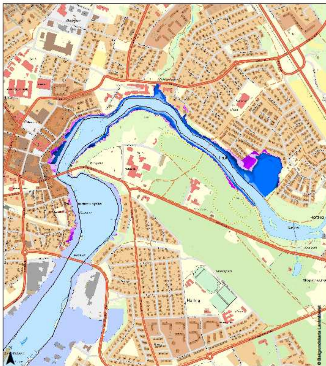
Bilaga 9a. Översvämningsskartering av Ätran vid Falkenberg med beräknat 100-årsvattenstånd i havet vid slutet av seklet. Karta 1.
