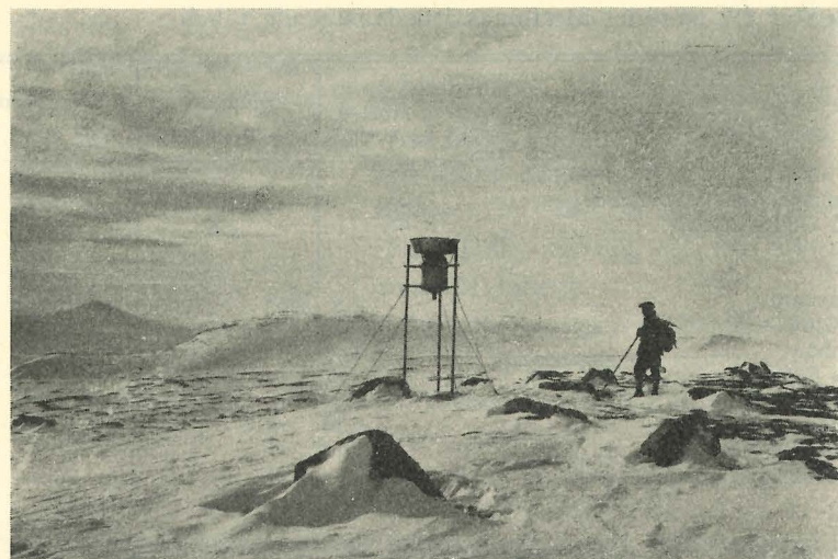
Fig. 6. Nederbördssamlaren »Bolagskammen». Fot. 10/4 1929. The totalizer »Bolagskammen».
