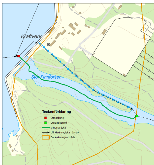
Figur 8. Exempel över hur uttagspunkt, utsläppspunkt och minussträcka i förhållande till Hydrografi i Nätverk och delavrinningsområdet.
