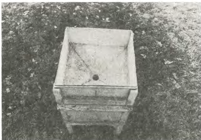
Figur 2. Celsius nederbörds­mätare (udometer) sedd snett uppifrån. Foto förf. 1979.
