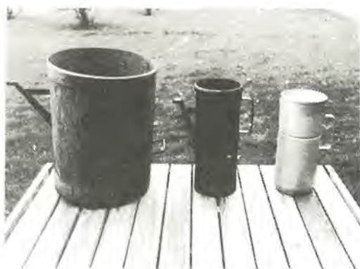
Figur 6. Nederbördsuppsamlingskärlet av den typ som använts vid nederbördsräkningar på Observatoriekullen. Den gamla vänstra försågs med vindskärm 1894. Det mellersta, mörka nederbörds-kärlet, medförde större avdunstningsförluster än den högra, numera sedan 1960 använda nederbördsräkaren. Foto. förf. 1979.
