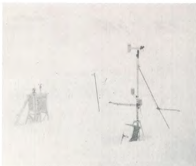
Figur 3. Väderstationen till höger mäter temperatur med två olika sorters sensorer, luftfuktighet samt in- och utstrålning. I toppen sitter vindgivaren som mäter vindens hastighet och riktning. Dataloggern registrerar dessa värden som max- och minvärden med tidsangivelser samt medelvärden, i några fall även med standardavvikelser. Till vänster syns en instrumentbur där observationer utförs när stationen är bemannad. Skålkorsanemometern på burens tak blåste sönder under vinterns stormar.
