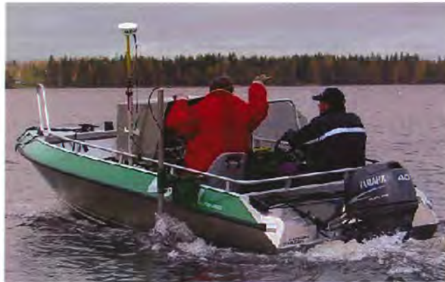
Figur 6. Det finska mätlaget utförde lodningarna i den nedre delen av älvsträckan från båt.
