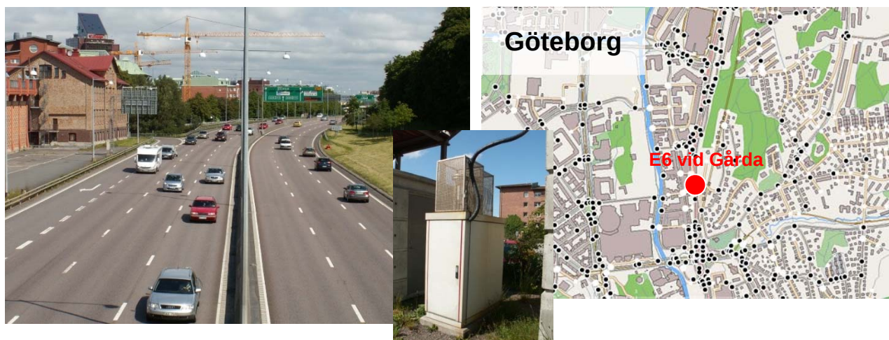
Figur 1. E6 vid Gårda i Göteborg. Mätstationen är placerad på vägens västra sida vid ett betongfundament vid en gångbro. Trafikmiljön är av bred och halvöppen karaktär och trafikerades av ca 90 000 fordon per dygn.
