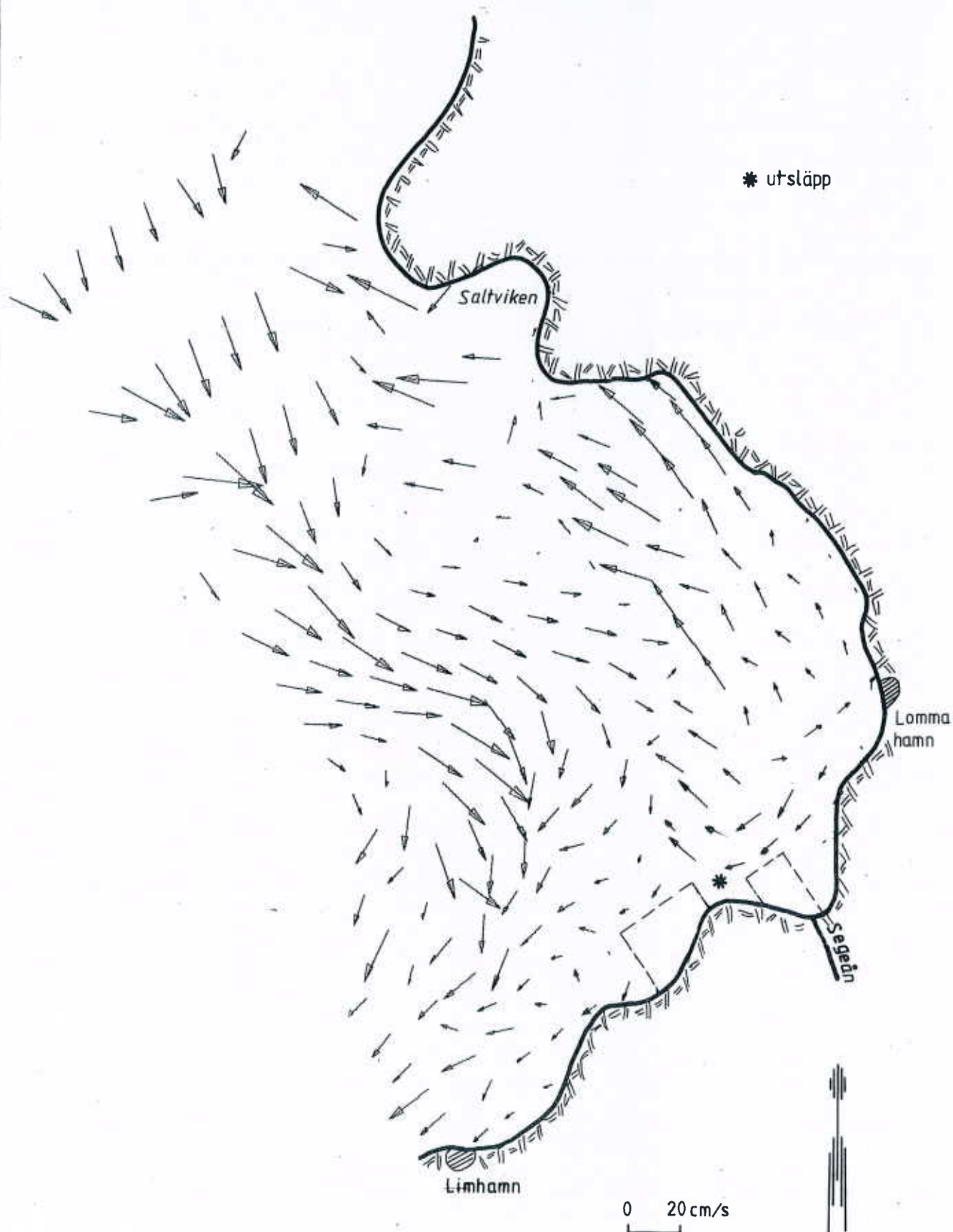
Figur 29 Sydgående ytström utanför Landskrona, 15 cm/s, utfyllt vid Malmö hamn och Spillepeng
