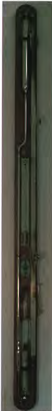
Äldre barometer som anger lufttrycket i millimeter kvicksilver (mm Hg)
