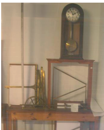
Figur 2. Till vänster visas en mareograf (vattenståndsmätare eller pegel), som användes av SMHI och dess föregångare 1886-1966. Vattenståndsändring överförs från flottören via stång, kedja, hjul och kuggstång till ett diagram (mareogram). Registreringarna har digitaliserats och finns nu lagrade i en databas på SMHI. Till höger visas dagens utrustning för att mäta havsvattenstånd. Mätvärden skickas kontinuerligt. Varje timme insamlas sex 10-minutersvärden, högsta och lägsta vattenstånd samt värdet på hel timme. Vid behov eller efter särskilda händelser, kan minutvärden fås från stationerna. En skrivare registrerar vattenståndet grafiskt på ett diagram, vilket används som en backup vid bortfall av den automatiska datainsamlingen.
