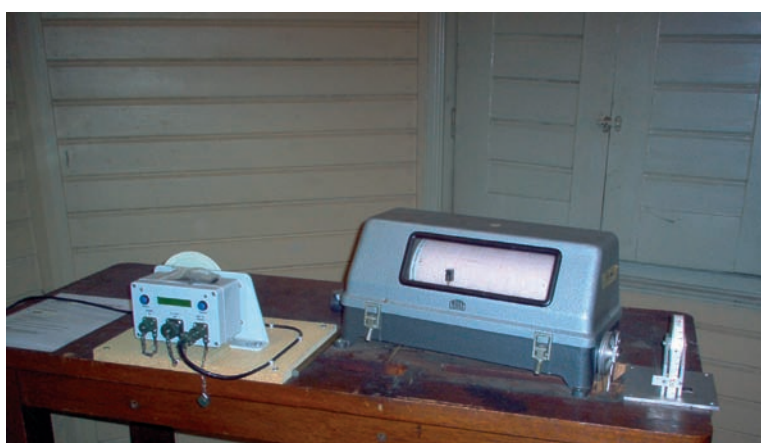
Figur 2. Till vänster visas en mareograf (vattenståndsmätare eller pegel), som användes av SMHI och dess föregångare 1886-1966. Vattenståndsändring överförs från flottören via stång, kedja, hjul och kuggstång till ett diagram (mareogram). Registreringarna har digitaliserats och finns nu lagrade i en databas på SMHI. Till höger visas dagens utrustning för att mäta havsvattenstånd. Mätvärden skickas kontinuerligt. Varje timme insamlas sex 10-minutersvärden, högsta och lägsta vattenstånd samt värdet på hel timme. Vid behov eller efter särskilda händelser, kan minutvärden fås från stationerna. En skrivare registrerar vattenståndet grafiskt på ett diagram, vilket används som en backup vid bortfall av den automatiska datainsamlingen.
