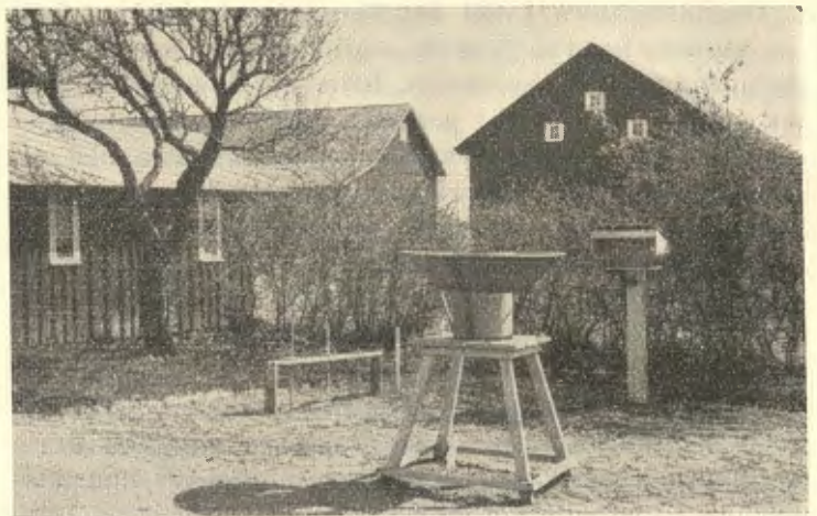
Fig. 1. Nederbördsjätmare med 1 000 cm 2 uppsamlingsyta och försedd med skärm. Uppställd vid stationen Lanna i Västergötland. Precipitation gauge with a sampling area of 1 000 cm 2 and screen equipment. Erected at Lanna in Västergötland.
