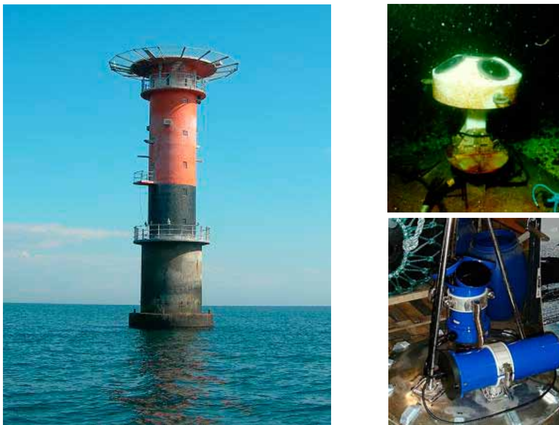
Figur 2. Till vänster visas fyrkassunen vid Fladens grundområde. I den övre till höger visas en DCM (Directional Current Meter). Instrumentet var placerat på 16 meters djup och kopplat via en sjökabel till en dator som var stationerad i fyren. Från fyren skickades sedan data till SMHI en gång per timme via mobiltelefonnätet. I den nedre till höger visas dagens teknik för strömmätning, en s.k. Acoustic Doppler Current Profiler (ADCP).
