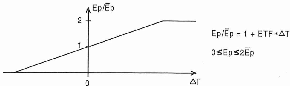
Figur 32 Modellsamband för korrigering av potentiell avdunstning. \bar{E}_p = långtidsmedelvärde för potentiell avdunstning, E_p = korrigerad potentiell avdunstning, ETF = en modellparameter och \Delta T = den aktuella temperaturens avvikelse från långtidsmedelvärdet.
