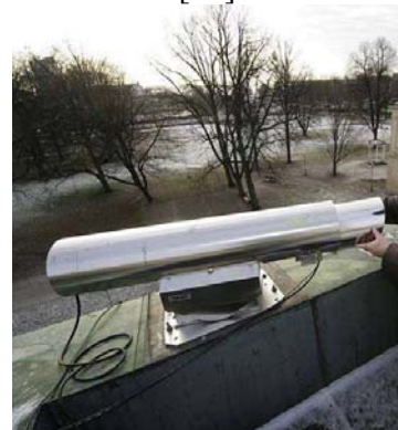
Figur 25. Mätningar av \text{NO}_2 och \text{O}_3 sker mellan Stadshusets tak och taket på Polishuset i Västerås med DOAS-instrument. Röd markering anger ljusstrålens ungefärliga väg. Mer om mätningarna finns att läsa i [13].
