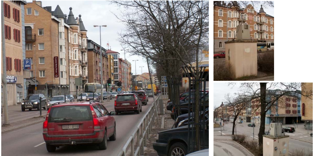
Figur 12. Vid det centralt belägna gaturummet Hamngatan i Karlstad mäter Miljöförvaltningen i kommunen PM10 med SM 200 instrument (filtermätningar). Gaturummet är 20 meter brett, och består av 5-6 våningar, ca 20 meter höga hus på norra sidan och parkeringsplatser/grönytor varvat med lägre byggnader på södra sidan. Strax öster om mätstationen finns ett ca 8 meter högt parkeringshus. Trafikflödet är ca 15 000 fordon per årsmedeldygn (Jan Johansson, Miljöförvaltningen i Karlstad).
