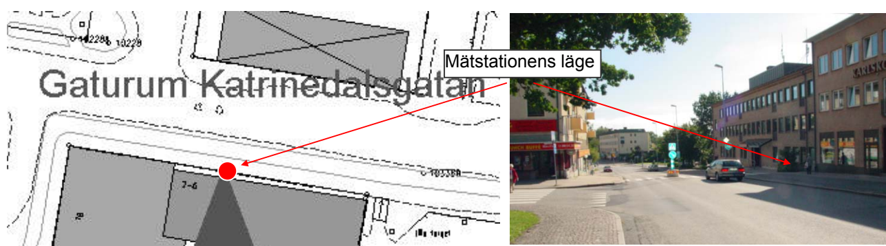
Figur 11. Vid Katrinedalsgatan i Karlskoga utför kommunen mätningar av PM10 sedan vinterhalvåret 2005/2006. Stationens läge framgår av de röda markeringarna. Vid mätplatsen omgärdas gatan av 10 meter höga 3-våningshus, annars är gatumiljön av tämligen öppen karaktär då Stora Torget samt ett grönområde finns i närheten. Trafikflödet är ca 6500 fordon/dygn, varav 4% tung (från Leif Gustafsson, Miljö- och Hälsoskyddsavdelningen i Karlskoga kommun).
