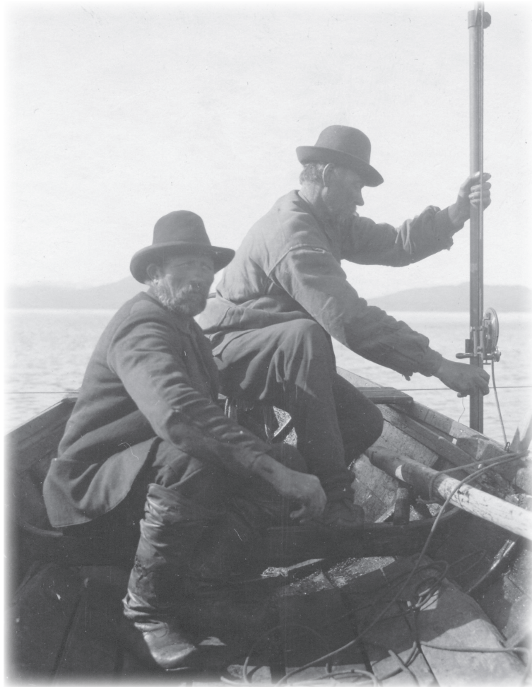
Det har gått 99 år sedan bilden togs av de hårdföra män som genomför en vattenföringsmätning i Tarrakoski den 21 juni 1909!
