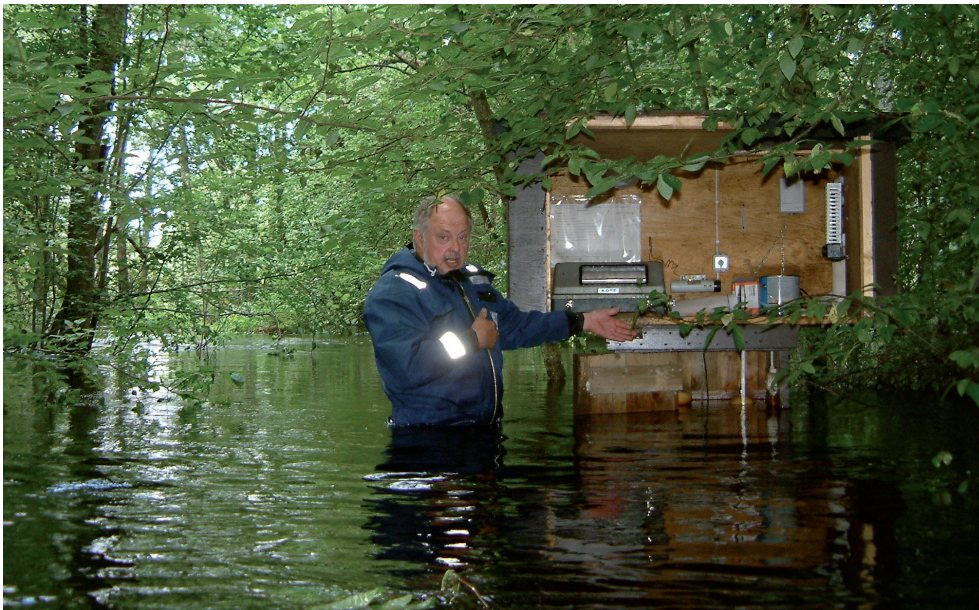
Hydrolog Hans-Erik Johansson inspekterar den registrerande pegeln vid Skye kvarn i ett tillflöde till Mörrumsån under översvämningarna den 20 juli 2004. Stationen fungerade vid tillfället! Foto: Mattias Ryman.
