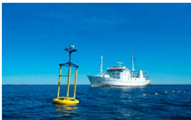
Figur 2. Till vänster visas havsbojen öster om Läsö. Bojen har varit i drift sedan 2001 och mäter förutom vågor flera oceanografiska parametrar på olika djup (i bakgrunden forskningsfartyget Argos). Till höger visas utsättning av en vågboj (WaveRider) för mätning av vågor och ytvattentemperatur.
