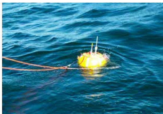
Figur 2. Till vänster visas havsbojen öster om Läsö. Bojen har varit i drift sedan 2001 och mäter förutom vågor flera oceanografiska parametrar på olika djup (i bakgrunden forskningsfartyget Argos). Till höger visas utsättning av en vågboj (WaveRider) för mätning av vågor och ytvattentemperatur.
