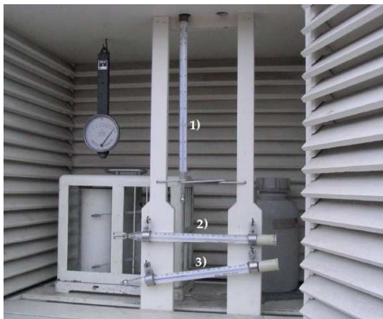
Figur 6. I termometerburen ser vi hårhygrometern hängande uppe till vänster och en registrerande termohygrograf nere till vänster. I buren finns också en termometer(1) samt en minimi-(2) och en maximitermometer(3). Foto Pelle Åberg.
