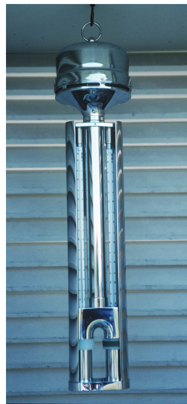
Figur 5. Assmannspsykrometer. Foto L-G Nilsson, Skylight.
