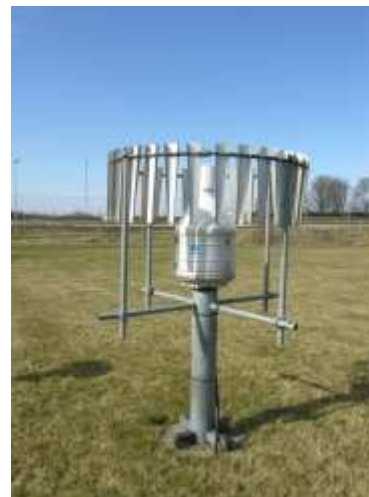
Figur 3. Nederbördsmätare vid automatiska stationer.
