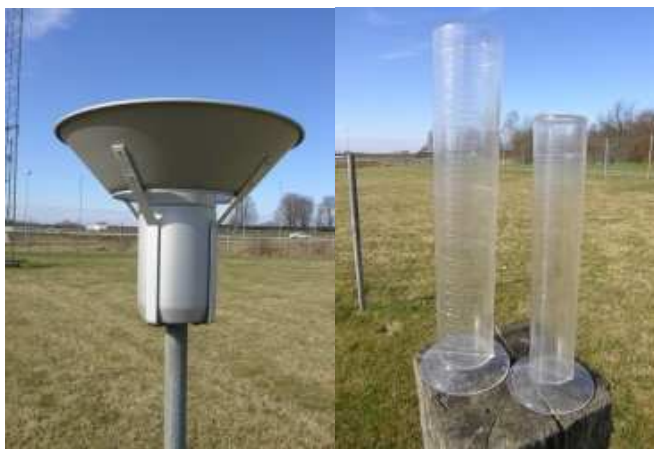
Figur 2. Dagens nederbörds kärlet med vindskydd för manuell nederbörds mätning till vänster och mätglas för att mäta mängden nederbörd till höger.
