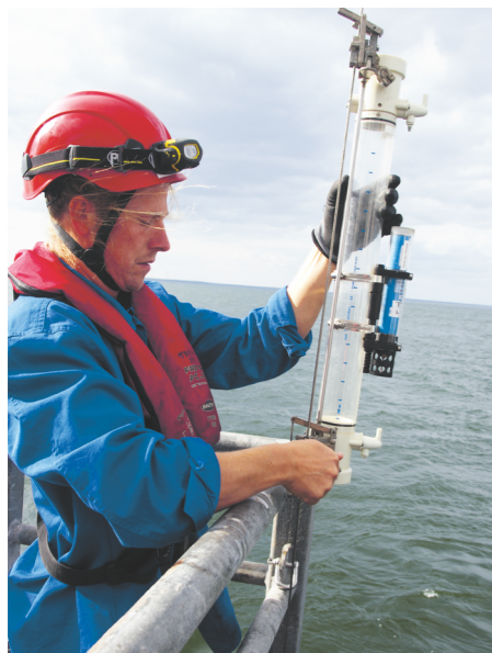
En hydrografisk vattenhämtare med termometer hängs ut för vattenprovtagning i Östersjön.
