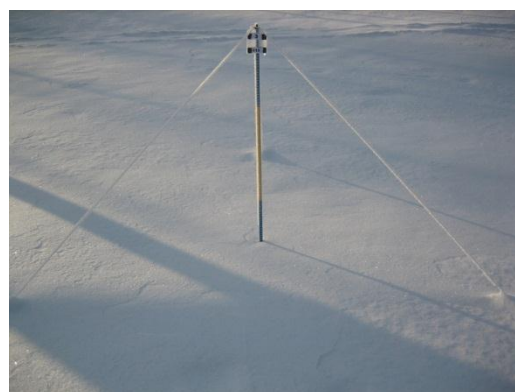
Figur 2. Mätpinne för snödjup vid SMHIs mätplats i Norrköping. Foto SMHI.
